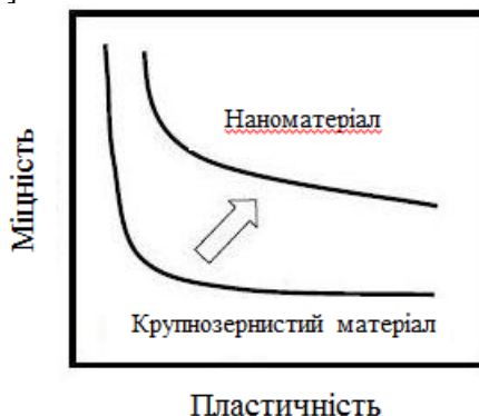
Рис. 2 – Співвідношення між міцністю і пластичністю для крупнокристалічних і нанокристалічних матеріалів [8]
