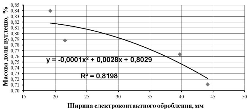
Рис. – Зміна масової долі вуглецю (С) за шириною поверхневого шару сталі 70Г після електроконтактного оброблення (L)
